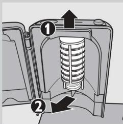
**4 Снимите защитный экран перед ультрафиолетовой лампой.**
