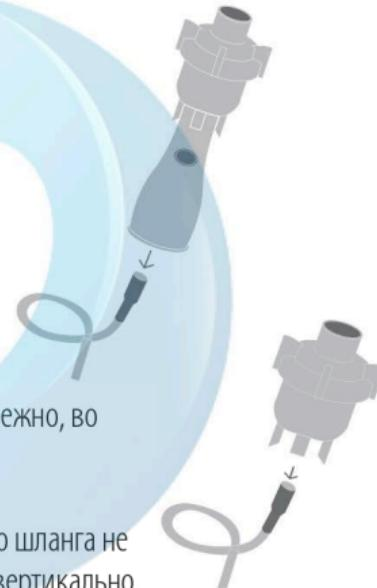
Присоедините другой конец воздушного шланга к разъему прерывателя воздушного потока или к разъему воздушного шланга распылителя в нижней части распылителя.
